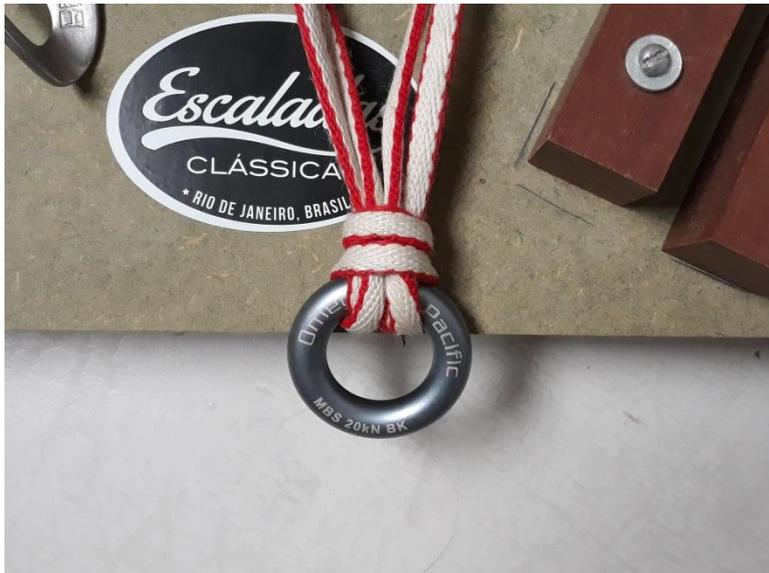
Obs: O anel evita a força em três eixos (ou quatro eixos), algo que acontece quando utilizamos o mosquetão como master point.
