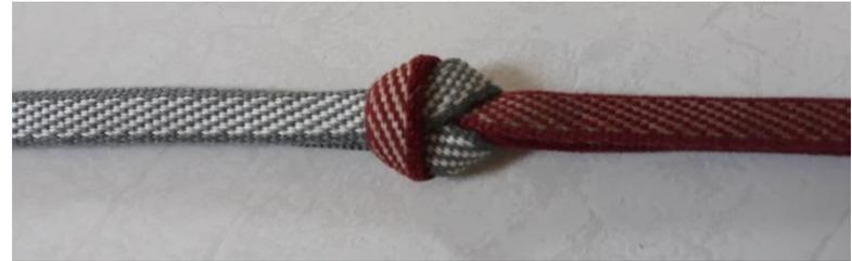
Em testes com carga dinâmica da Black Diamond a resistência das fitas variou de 9 KN no pior cenário (6mm Dyneema com 11/16 Nylon) até 14 KN na melhor configuração (11/16 Nylon e 11/16 Nylon)
