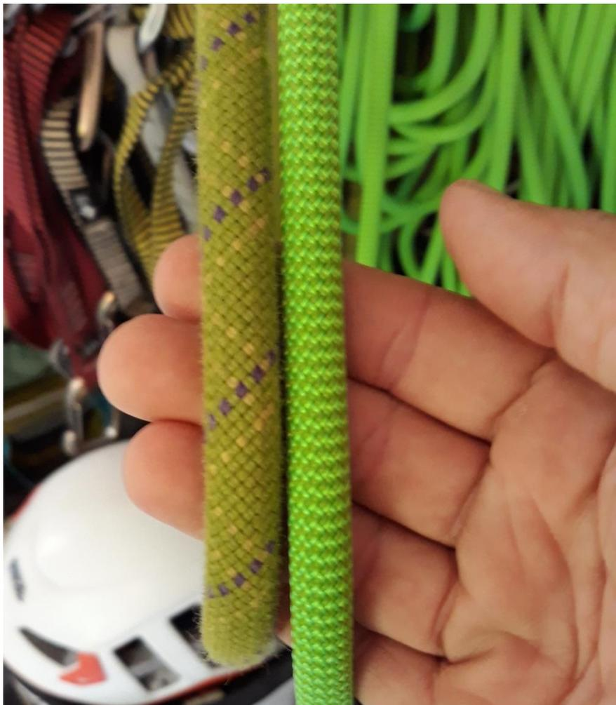
Na esquerda uma corda com aproximadamente dois anos de uso e na direita uma novíssima da mesma marca e modelo com 9.5mm.
