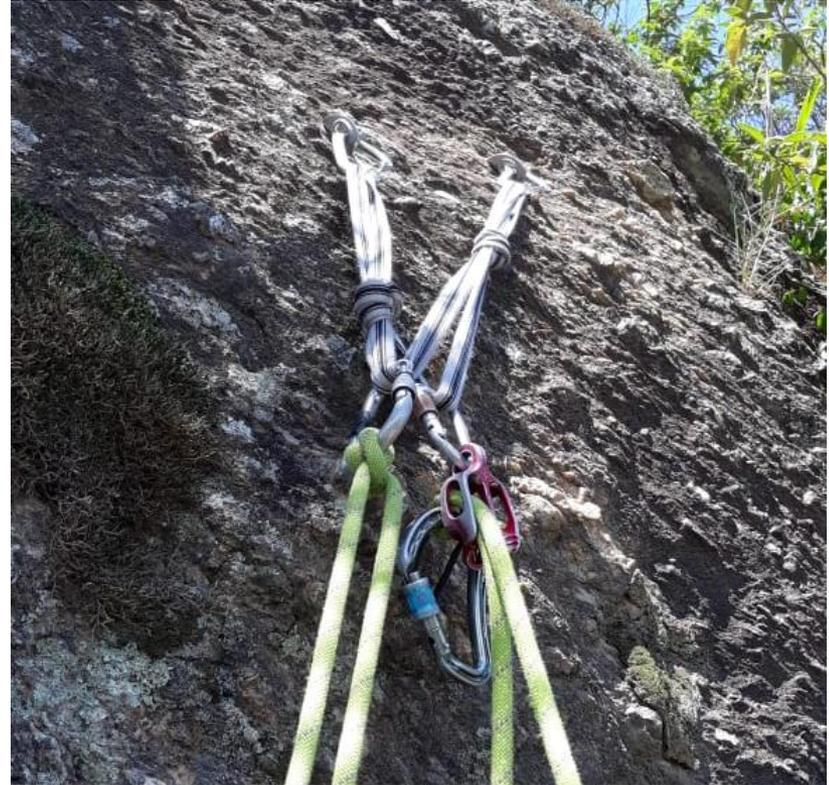
Fiel sendo utilizado como ancoragem pessoal (“solteira”) em uma parada dupla tipo Quad, utilizando uma fita de Nylon de 240cm e dois mosquetões simples nas proteções fixas.
